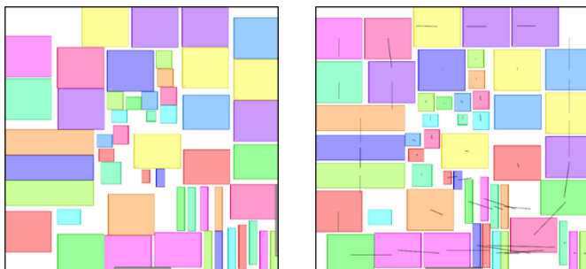
Computerchip-ontwerp voor en na optimalisatieslag. In de rechterafbeelding zijn elementen verschoven van hun originele positie (begin zwarte lijn) naar een correcte plaatsing (eindpunt zwarte lijn in het midden van het element.) Bron: Synopsys
