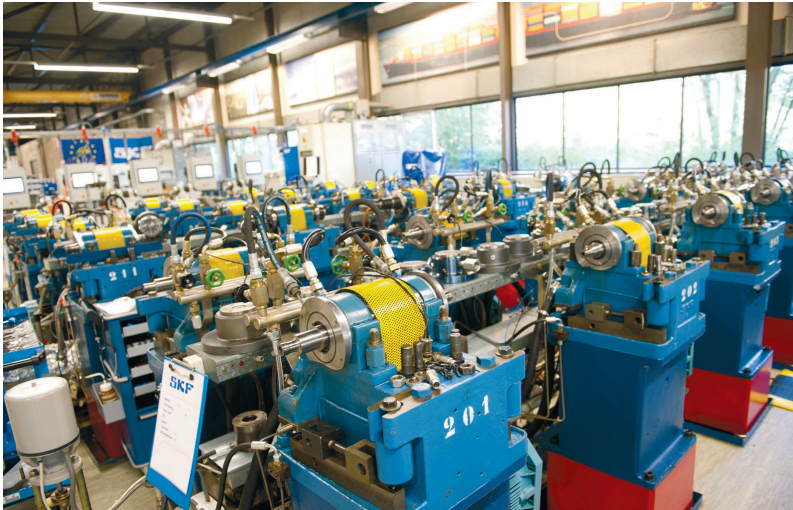
Testmachines voor lagers. Beeld: SKF
