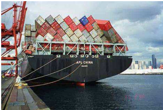
Voorbeelden van de gevolgen van de rolbeweging van een containerschip.
