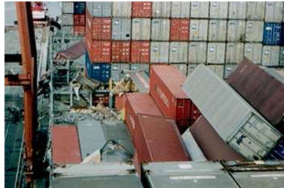
Voorbeelden van de gevolgen van de rolbeweging van een containerschip.
